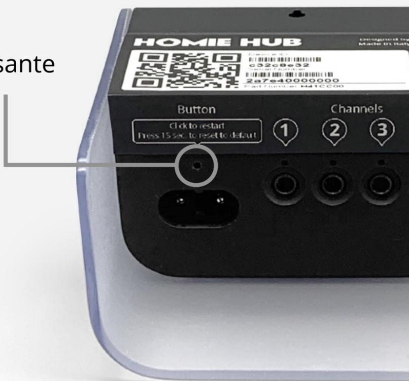
Puoi premerlo, senza scollegare il connettore dell'alimentazione, utilizzando una clips o la punta di una matita micromina.
